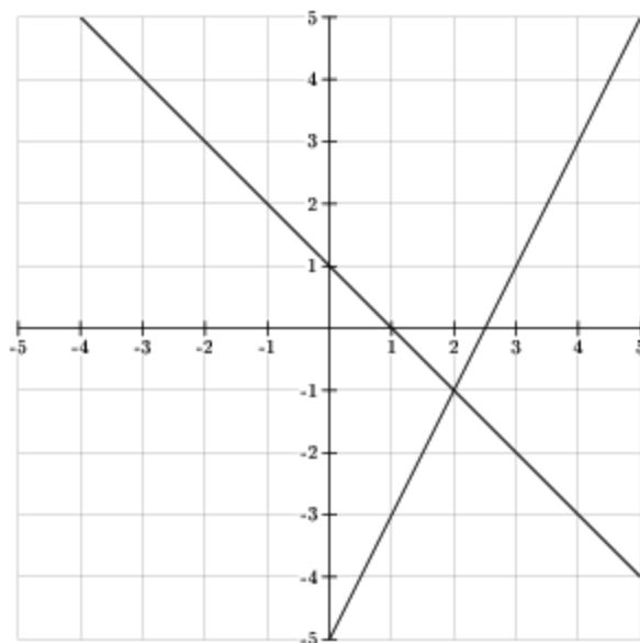
La solution du système est donnée par les coordonnées du point d'intersection des deux droites, c'est-à-dire  $(2 ; -1)$ , ce qui signifie que  $x = 2$  et  $y = -1$ .
