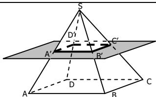
La section d'une pyramide par un plan parallèle à la base est un polygone de la même nature que la base.
