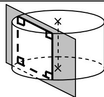
La section d'un cylindre par un plan parallèle à l'axe du cylindre est un rectangle.
