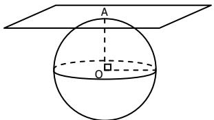
$OA = R$  : la section de la sphère par le plan est le point  $A$ . On dit que le plan et la sphère sont « tangents ».
